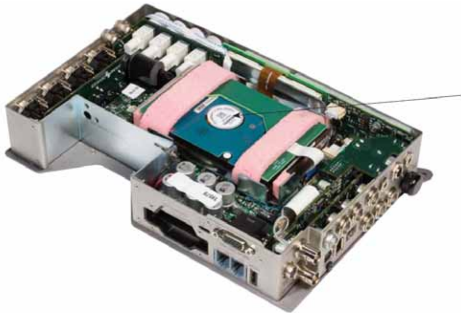
788Tのボトムパネルを外すと、ハードドライブがマウントされています。
